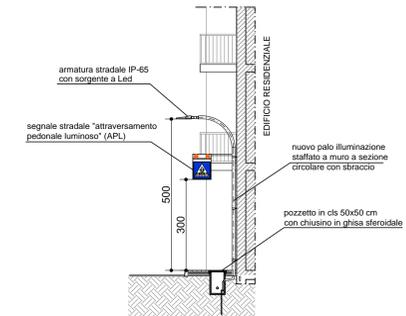
PIANTA COLLEGAMENTO TRA PALO "APL" A MURO
