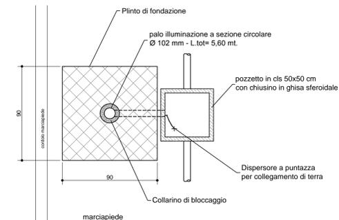
PIANTA PLINTO DI FONDAZIONE PALINA "APL"
